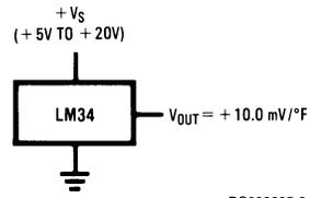
**FIGURE 1. Basic Fahrenheit Temperature Sensor
